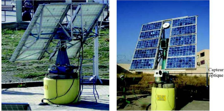
Fig. 5: Vue du dispositif de poursuite sur le site avec positionnement du capteur optique et des pyranomètres
