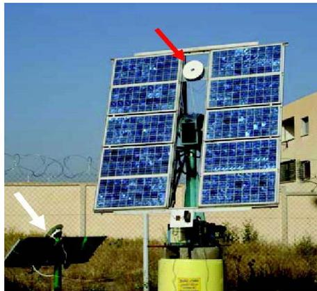
Fig. 12: Emplacement des pyranomètres
