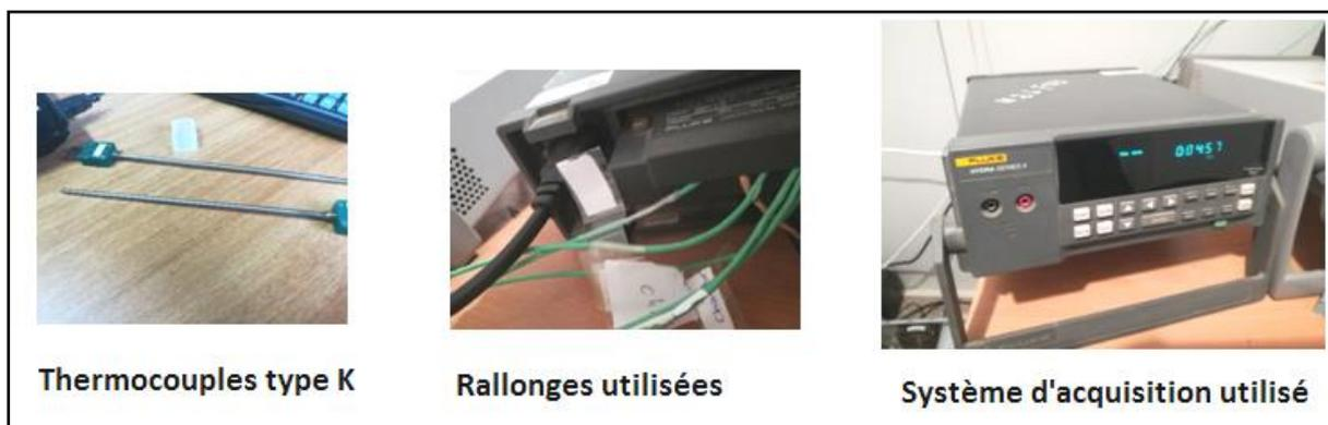
Fig 3. Matériel expérimental utilisé
