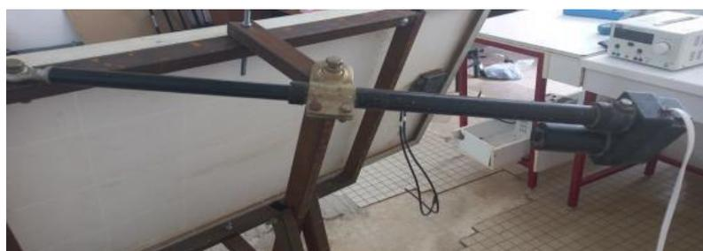
Fig. 2 The first actuator
