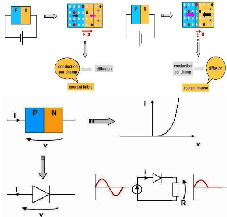
Fig. 9: Caractéristiques et fonctionnement d'une jonction P-N
