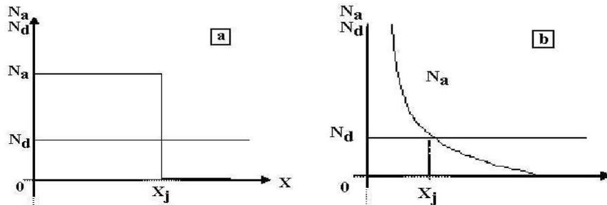
Fig. 8: Variation des concentrations des donneurs et des accepteurs dans une jonction abrupte (a) et dans une jonction graduelle diffusée (b)
