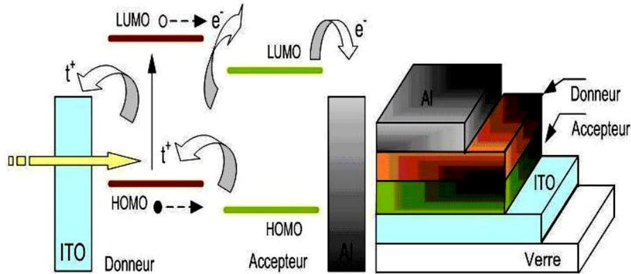
Fig. 2: Structure d'une cellule hétérojonction (à droite) et représentation des niveaux d'énergie d'un contact ITO/donneur/accepteur/Al (à gauche)
