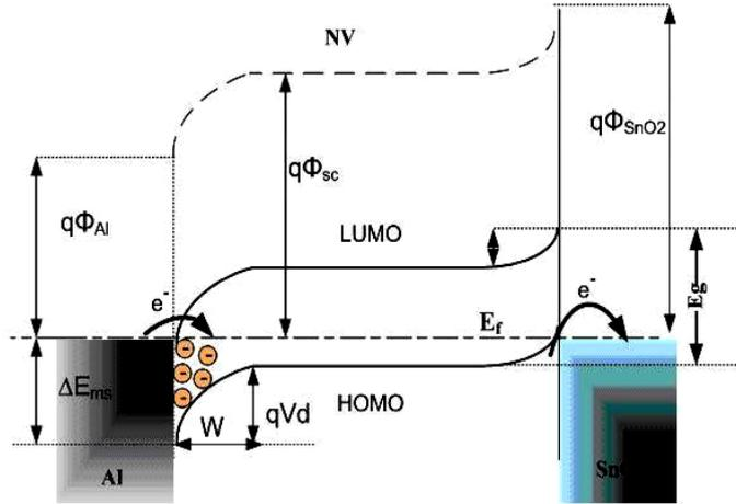
Fig. 7: Diagramme des bandes d'énergie à l'équilibre thermodynamique
