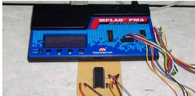
Fig. 10: Transfert des données vers le microcontrôleur
