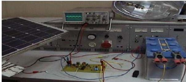
Fig. 12: Fonctionnement du système complet- Charge de la batterie
