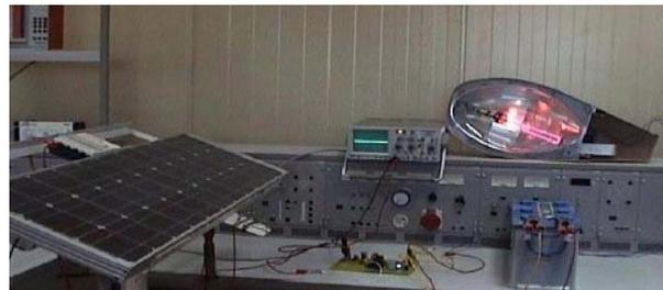
Fig. 13: Fonctionnement du système complet- Allumage de la lampe
