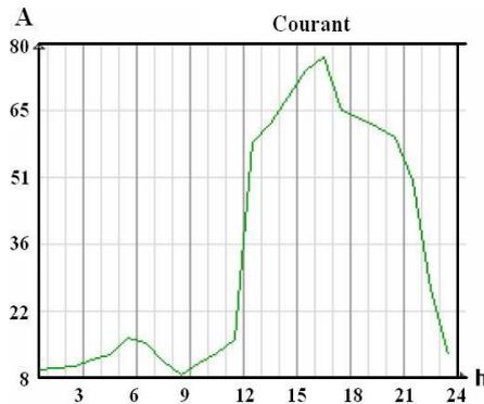
Fig. 11: Courant transité en ligne après compensation photovoltaïque
