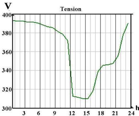
Fig. 5: Chute de tension chez le dernier abonné avant compensation
