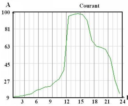
Fig. 10: Courant transité en ligne avant compensation photovoltaïque
