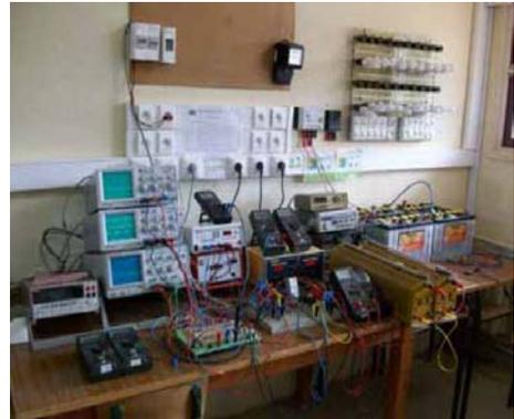
Fig. 3: Banc de mesure mis en place pour caractériser les panneaux et les systèmes photovoltaïques
