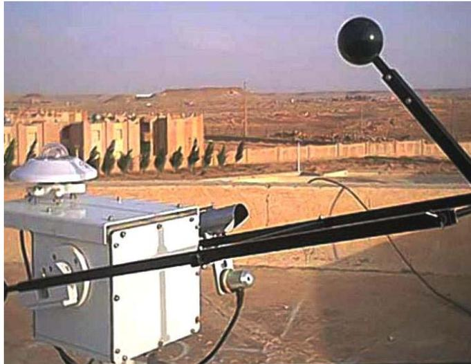
Fig. 1: Vue d'ensemble de la station radio métrique (SunTracker)
