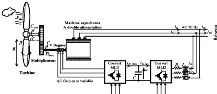
Fig. 5: Machine asynchrone à double alimentation
