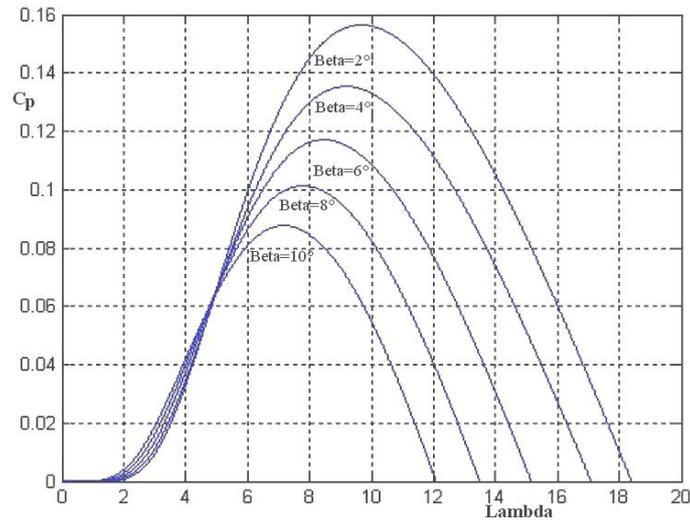
Fig. 1: Coefficient de puissance en fonction du ratio de vitesse ( $\lambda$ ) et de l'angle de calage ( $\beta$ )
