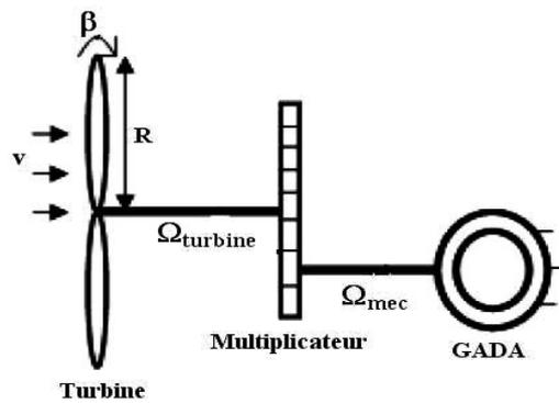
Fig. 3: Structure du système de conversion éolien
