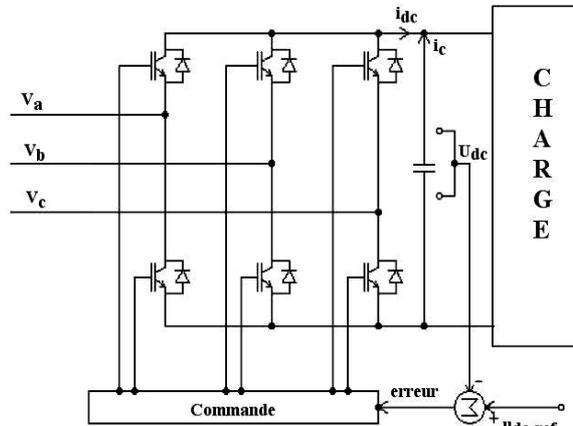
Fig. 5: Topologies de base d'un redresseur de tension
