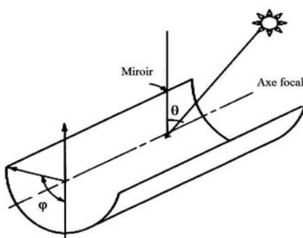
Fig. 5: Angles d'incidence et d'ouverture
