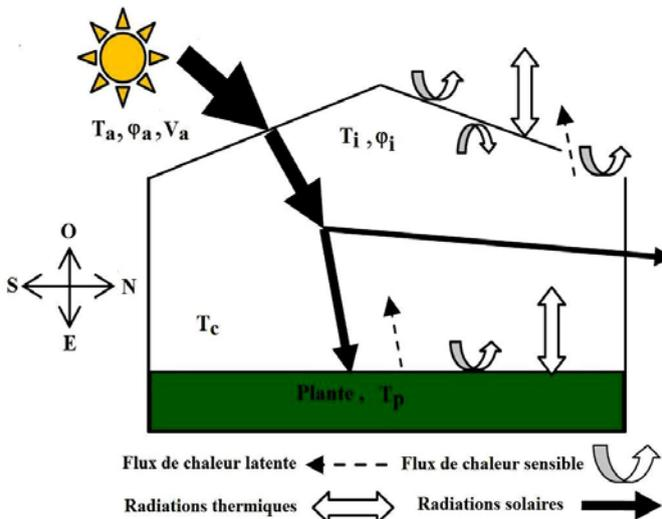
Fig. 2: Mécanismes de transfert énergétique dans la serre
