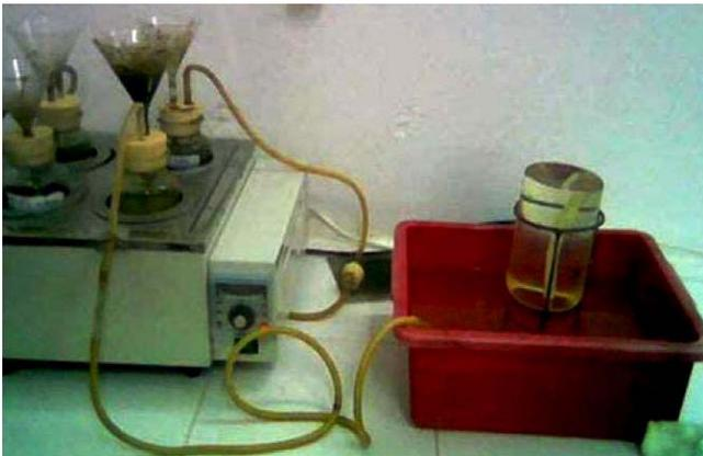
Vue 4: Système adopté de quantification du biogaz expérimental
