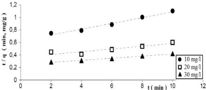
Fig. 9: Présentation du modèle de Blanchard sur trois solutions : 10, 20, 30 mg/l
