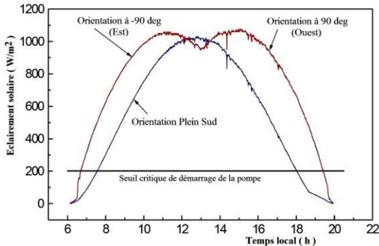
Fig. 6: Evolution de l'éclairement solaire mesuré sur un plan orienté plein sud et incliné à la latitude d'Adrar comparé à celui mesuré sur un plan incliné à la latitude d'Adrar et pivotant entre deux positions fixes ( $\gamma = -90$  deg. et  $\gamma = 90$  deg.), (29/06/11)
