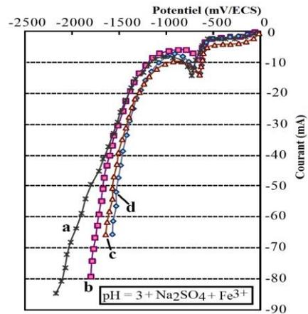
Fig. 9: Courbes de polarisation cathodique de l'électrode de plomb
