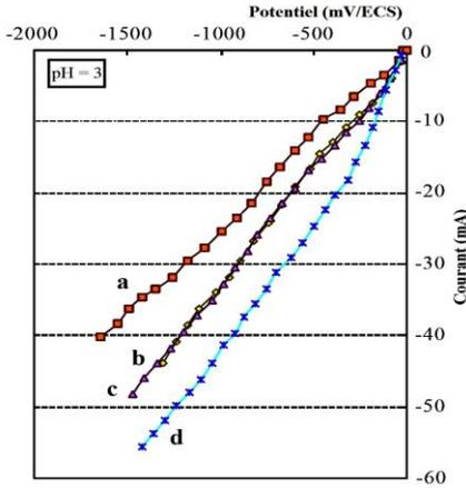
Fig. 8a-: Courbes de polarisation cathodique de l'électrode de plomb
