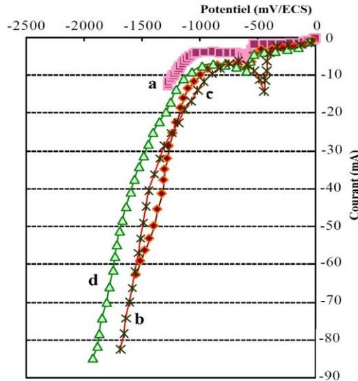
Fig. 10: Influence de l'addition du furfural sur les courbes de polarisation de l'électrode de plomb
