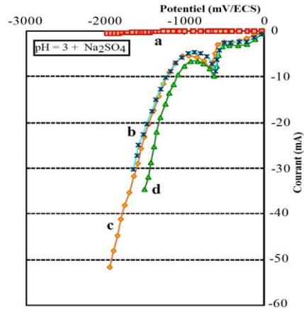
Fig. 8b-: Courbes de polarisation cathodique de l'électrode de plomb
