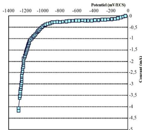
Fig. 6: Influence du Furfural sur la courbe de polarisation: électrode de mercure
