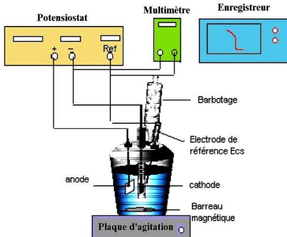
Fig. 1: Montage expérimental
