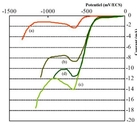
Fig. 7: Courbes de polarisation cathodique sur électrode de platine
