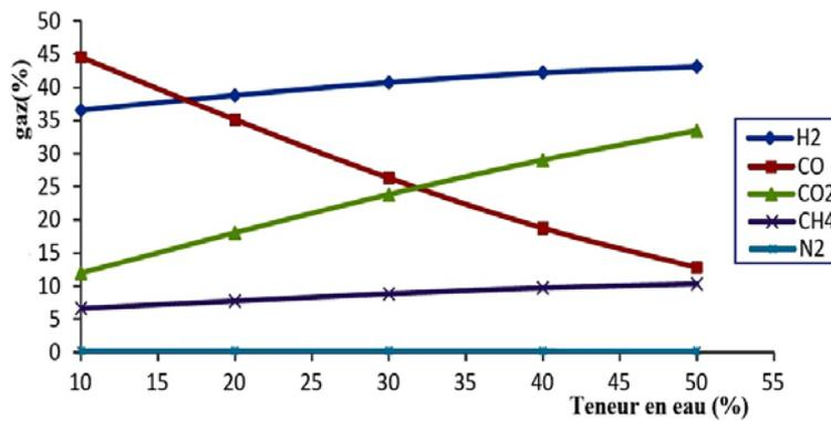
Fig. 2: Pourcentage molaire des espèces en fonction de la teneur en eau par kmol de bois à 800 °C (gazéifiée à l'air)
