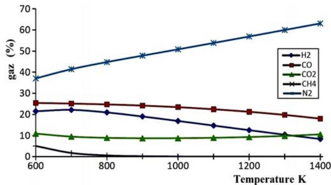
Fig. 5: Pourcentage molaire des espèces en fonction de la température (gazéifié à l'air)
