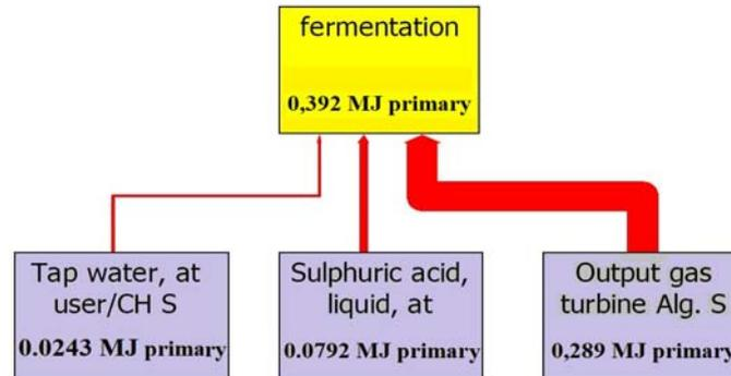
Fig. 4: Consommation en énergie fossile de la fermentation
