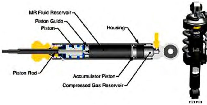
Fig. 18: Amortisseurs adaptatifs et intelligents
