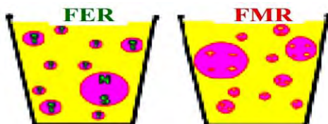
Fig. 3: Fluide ER et fluide MR avec des particules en suspension
