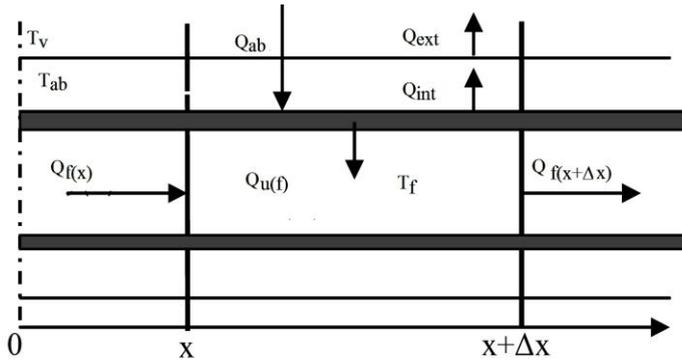
Fig. 2: Bilan thermique d'un élément  $\Delta x$  de l'absorbeur
