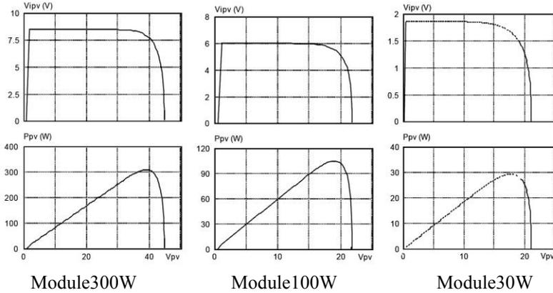
Fig. 11: Caractéristiques I-V et P-V obtenues par simulation en entrée des circuits de mesure de courant et de tension
