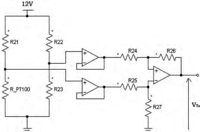
Fig. 6: Schéma du circuit de mesure de la température du module
