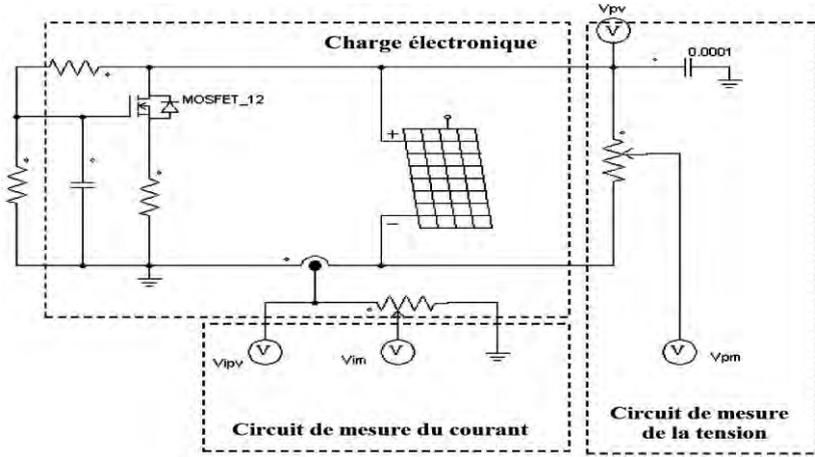
Fig. 10: Schéma de simulation de la charge électronique et des circuits de mesure de tension et de courant
