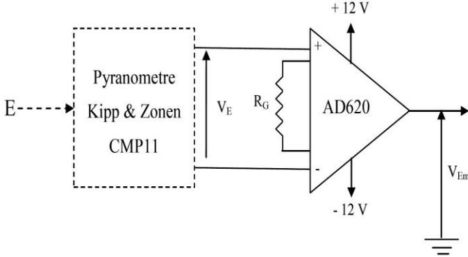
Fig. 5: Schéma du circuit de mesure de l'éclairement
