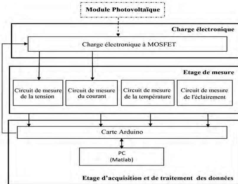
Fig. 1: Schéma synoptique du banc de mesure de I–V des modules photovoltaïques
