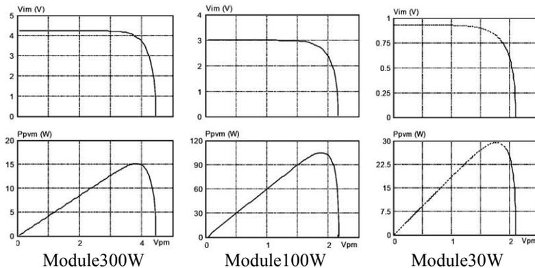
Fig. 12: Caractéristiques I-V et P-V mesurées en sortie des circuits de mesure de mesure de courant et de tension
