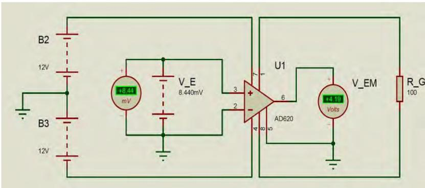
Fig. 13: Schéma de simulation du circuit de mesure de l'éclairement
