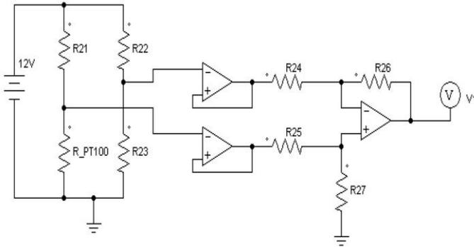
Fig. 14: Schéma de simulation du circuit de mesure de température
