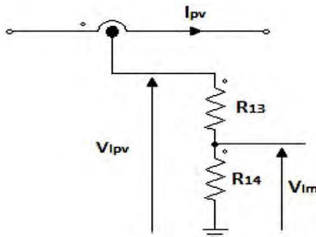
Fig. 4: Schéma du circuit de mesure de courant
