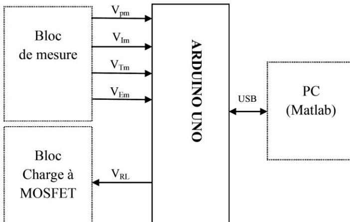
Fig. 8: Les connexions externes de la carte Arduino
