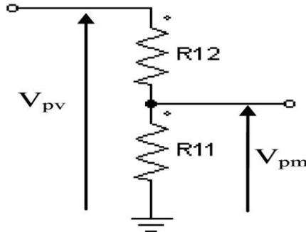
Fig. 3: Schéma du circuit de mesure de la tension
