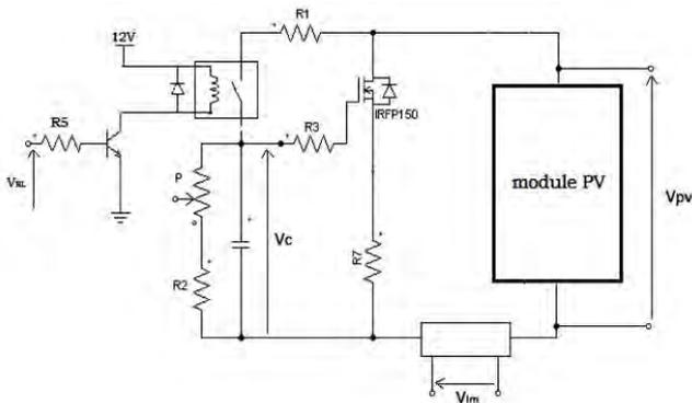
Fig. 2: Schéma électrique de la charge électronique à MOSFET [7]
