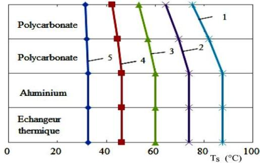
Fig. 3: Températures dans le capteur en fonction de la densité de flux solaire
