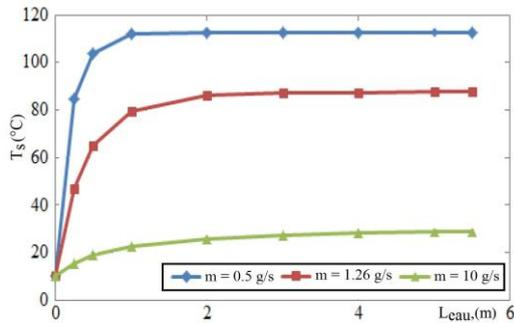
Fig. 8: Température de sortie du fluide caloporteur en fonction de longueur  $L_{\text{eau}}$  du tube parcouru par le fluide caloporteur pour différents débits massiques
