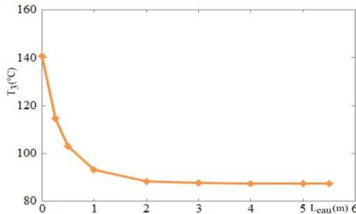
Fig. 7: Température de jonction  $T_3$  entre les plaques de polycarbonate et d'aluminium en fonction de longueur  $L_{eau}$  du tube parcouru par le fluide caloporteur
