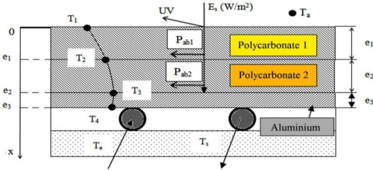
Fig. 2: Schéma du capteur hybride
