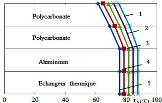
Fig. 4: Températures dans le capteur en fonction de la température ambiante
