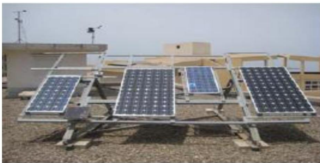
Fig. 1: Plateforme de tests 'outdoor' pour modules photovoltaïques (UDES)
