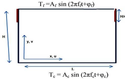
Fig. 1: a- Configuration géométrique et conditions aux limites
