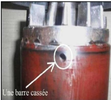
Fig. 3: Rotor avec une barre rotorique cassée
