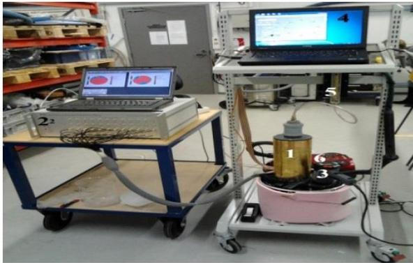
Fig. 1: Dispositif expérimental du séchoir convectif
