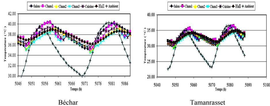
Fig. 4: Evolution de la température dans une maison typique sur 48 heures
