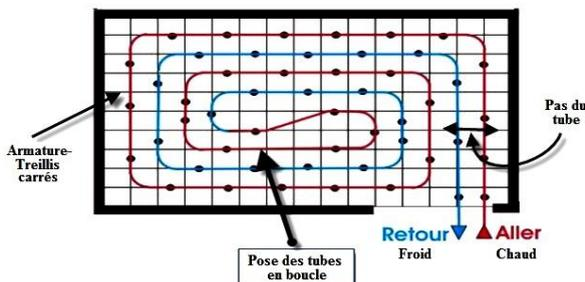
Fig. 3: Description de la grille de chauffage
