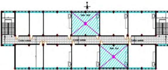
Fig. 3: Typologie de plan à corridor central
