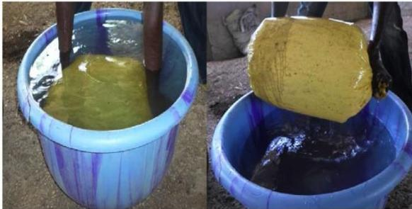
Fig. 2: Opération de mesure du volume du biogaz
