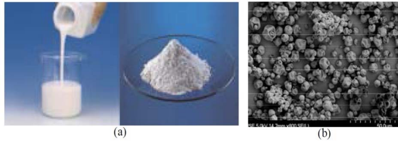
Fig. 3: MCP micro-encapsulés: (a) état liquide et état poudre (b) image microscopique électronique à balayage de nombreuses capsules [24]
