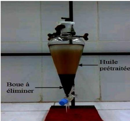
Fig. 1: Décantation après traitement à l'acide de l'huile usagée
