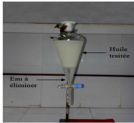
Fig. 2: Neutralisation de l'acide et son élimination par décantation
