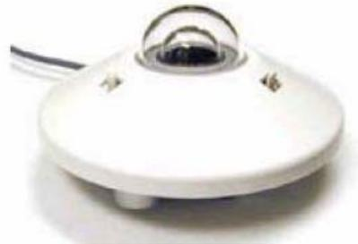
Fig. 6: Vue du pyranomètre utilisé CM11
