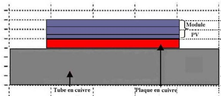
3<sup>ème</sup> configuration: Capteur hybride non recouvert
