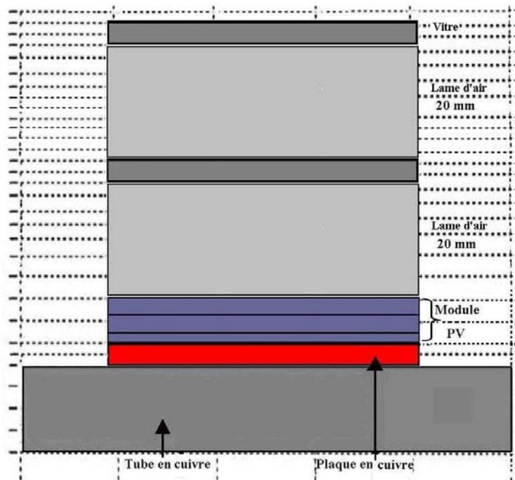
5<sup>ème</sup> configuration: Capteur hybride recouvert de deux vitres
