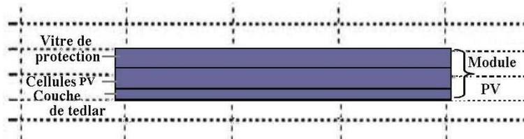
1<sup>ère</sup> configuration: Module photovoltaïque isolé thermiquement et non recouvert
