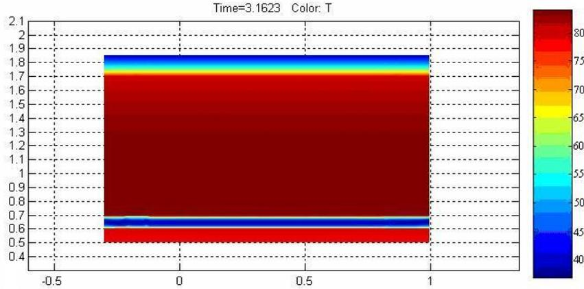
Fig. 8: Modèle thermique photovoltaïque + verre
