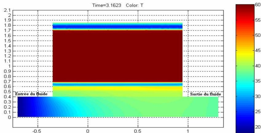
Fig. 10: Distribution de la température dans le capteur hybride avec vitre
