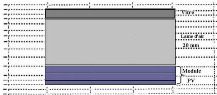
2<sup>ème</sup> configuration: Capteur photovoltaïque isolé thermiquement et recouvert d'une vitre
