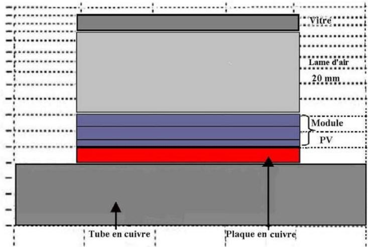
4<sup>ème</sup> configuration: Capteur hybride recouvert d'une vitre
