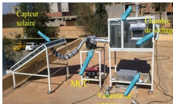
Fig. 2: Montage du séchoir solaire
