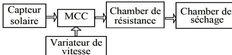
Fig. 1: Schéma bloc de séchoir solaire
