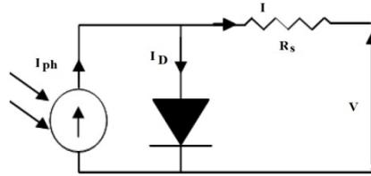
Fig. 7: modèle du panneau photovoltaïque
