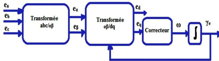
Fig. 10: Structure classique d'une PLL triphasée [21]
