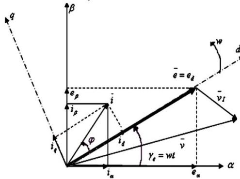
Fig. 11: Diagramme vectoriel de la commande du VOC
