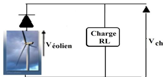
Fig. 6: Schéma couplage générateur éolien avec la charge
