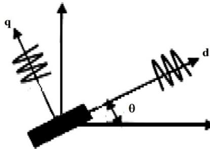
Fig. 3: Modèle de la machine en biphasé
