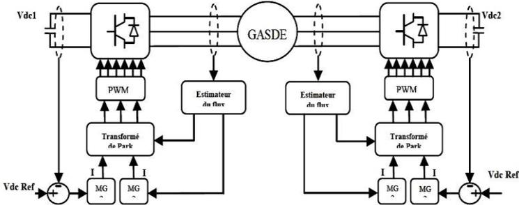
Fig. 3: Commande par mode glissant d'ordre supérieur de la GASDE
