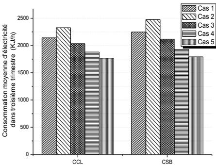
6-Isolation des murs(SI, IN, EX) et de la toiture(Tiso)
