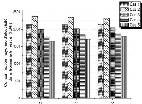
Un bon choix de type de la toiture permet de réduire la consommation d'énergie et aussi diminue la transmission de chaleur à l'intérieur de bâtiment surtout dans la période estivale. Pour les cinq cas simulés, on remarque que la consommation électrique la plus basse est enregistrée avec la toiture T3.
