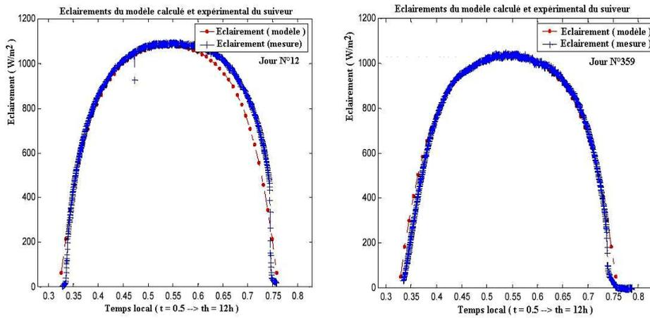
Fig. 5: Courbes des éclairements solaires en poursuite solaire du modèle de Brichambaut et ceux issus de l'expérimentation par jour clair
