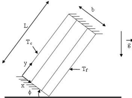
Fig. 1: Géométrie de la cavité partitionnée
