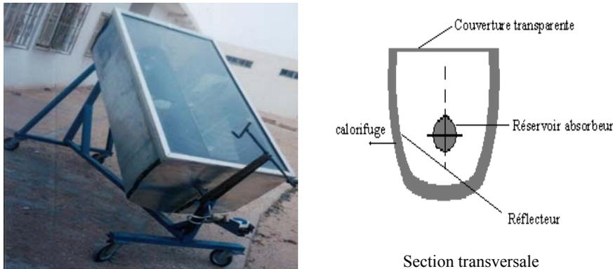
Fig. 1: Dispositif expérimental
