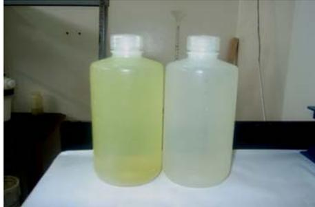
Fig. 2: Effluent avant et après électrocoagulation
