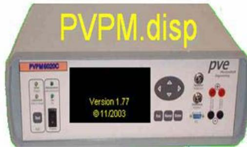
Fig. 2: Charge électronique pour caractérisation
