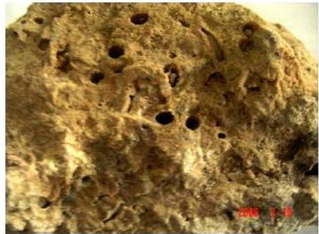
Fig. 11: Echantillon du traversin (vacuoles)
