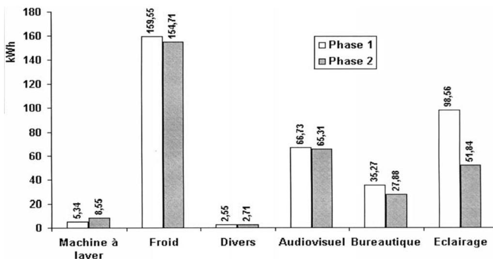
Fig. 8: Comparaison des consommations électrique poste par poste
