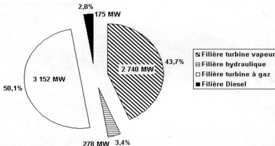
Fig. 1: Filières de production de l'énergie électrique
