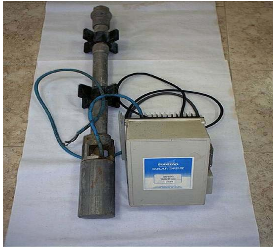
Fig. 1: Système de pompage SP1
