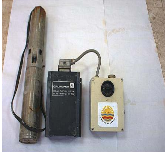
Fig. 7: Système de pompage SP3
