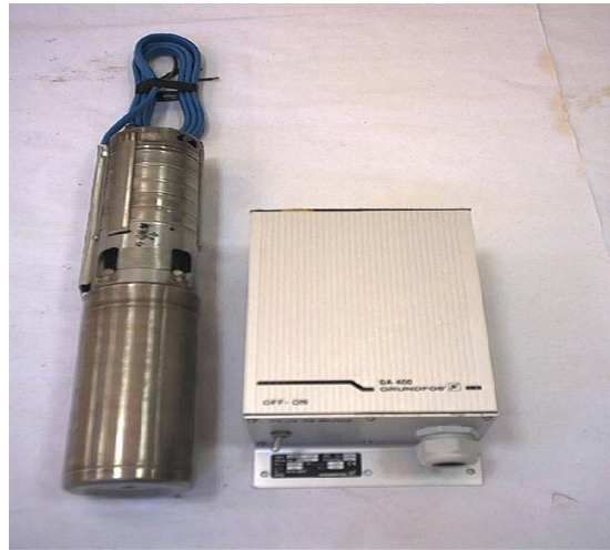
Fig. 2: Système de pompage SP2
