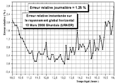
Fig. 5: Erreur relative du rayonnement global sur surface horizontale- 13/03/2008
