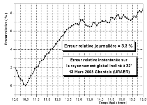
Fig. 7: Erreur relative du rayonnement global incliné à 32° - 13/03/2008
