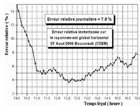
Fig. 17: Erreur relative du rayonnement global sur surface horizontale - 07/08/2006
