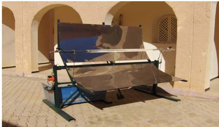
Fig. 9: Vue du concentrateur réalisé
