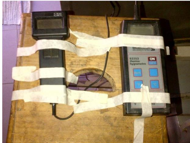
Fig. 5. Affichage des instruments utilisés pour la mesure à l'intérieur du séchoir
